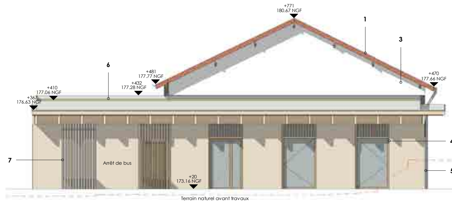
Elévation SUD Après travaux Ech : 1 : 100
