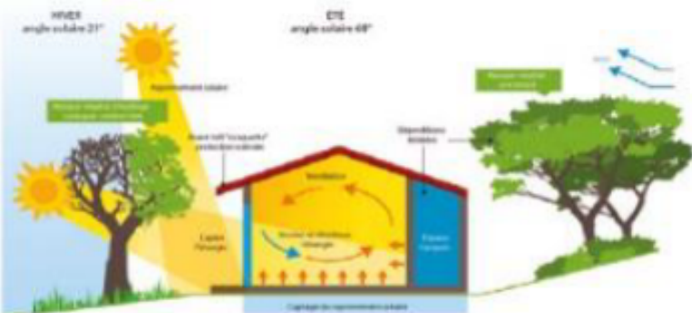
Figure 1 : Schéma représentant les principes de l'architecture bioclimatique (source: mamaisonbioclimatique.blogspot.fr )
